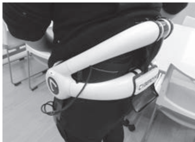
職員の負担軽減を目的とした「移乗介助・装着型」の介護ロボット 写真提供：社会福祉法人永友会 特別養護老人ホーム鶴亀ながい
